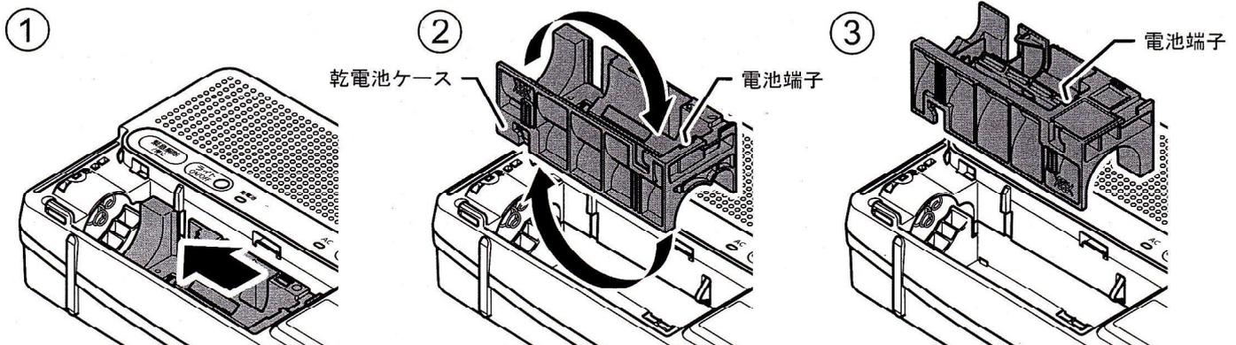
1. 上記の「乾電池の交換のしかた」に従い、乾電池を取り外します。
