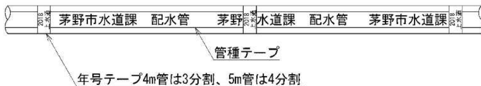
図 6－1－1 埋設管明示テープ施工例
