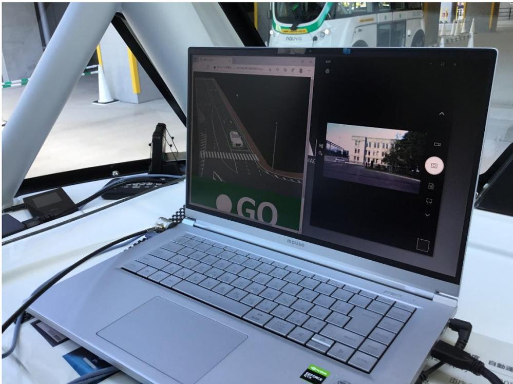
「インフラ協調」システムによる右折の安全度向上。路上に設置したカメラと協調して、対向車などを察知し、右折可能か不可かを判断している。データ蓄積により精度の向上を図り、他車が走っている公道でも、安全かつ交通の支障とならないタイミングでの右折を可能としている。
